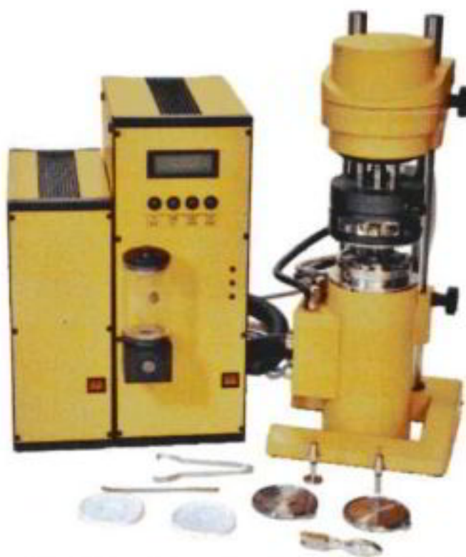
Рисунок 1 – Общий вид реометров RHEOTEST® RN
