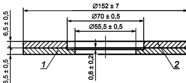
1 — термостойкая пластина; 2 — металлическая пластина
